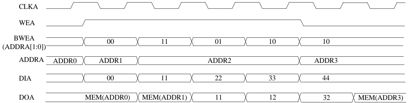
图 3-5 字节使能读写时序图 (TW 模式)
