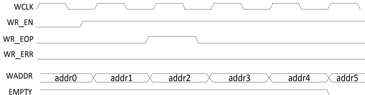
图 7-14 写丢包模式下写入空 FIFO 时序图
